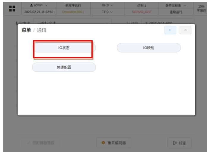
(3) 打开 IO 状态界面后如下图，点击圈中部分可查看不同类型的信号
