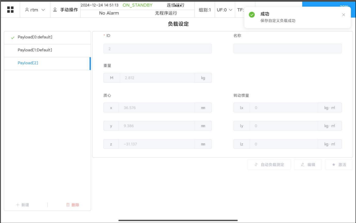
图 4.18 自动测定完成后的负载设定主界面
