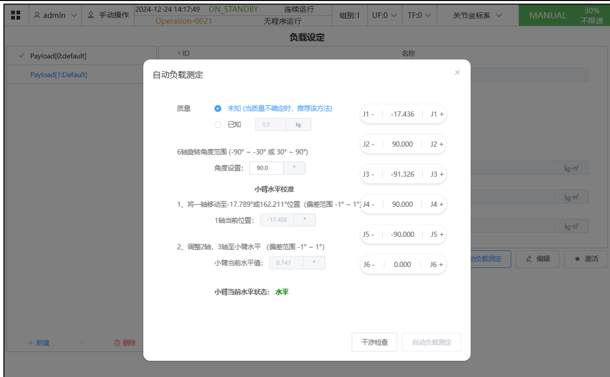
图 4.7 参数及 3 轴水平设置界面
